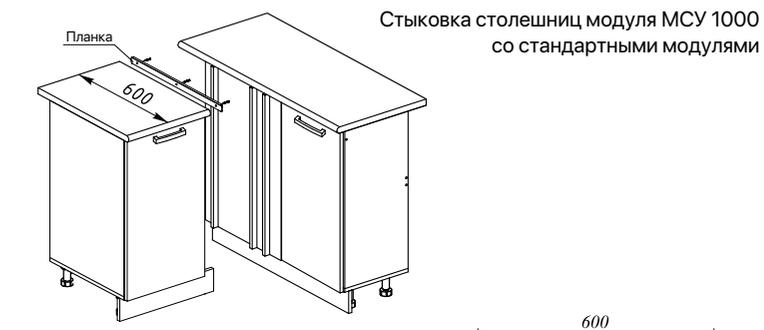
Стыковка столешниц модуля МСУ 1000 со стандартными модулями
