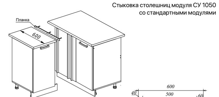
Стыковка столешниц модуля СУ 1050 со стандартными модулями
